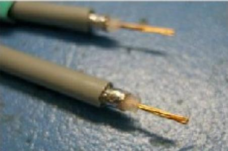
Consiste en un único cable rodeado de una capa de aislante y ésta a su vez de una malla metálica. La atenuación y las interferencias son menores que en el cable de par trenzado, mientras que el ancho de banda es superior, por lo que se utiliza en redes de ordenadores, televisión por cable y telefonía de media o larga distancia.
