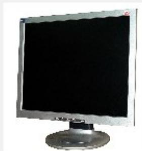
Está compuesto por moléculas de cristal líquido; de ahí su nombre, pantalla LCD (liquid crystal display). Estas moléculas actúan como interruptores que encienden y apagan cada uno de los muchos puntos o píxeles de la pantalla; este encendido se regula mediante transistores TFT, de ahí el otro nombre que reciben estas pantallas.
