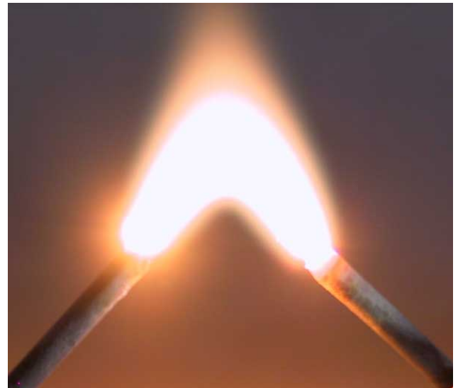
Arco eléctrico de 3000 voltios.
